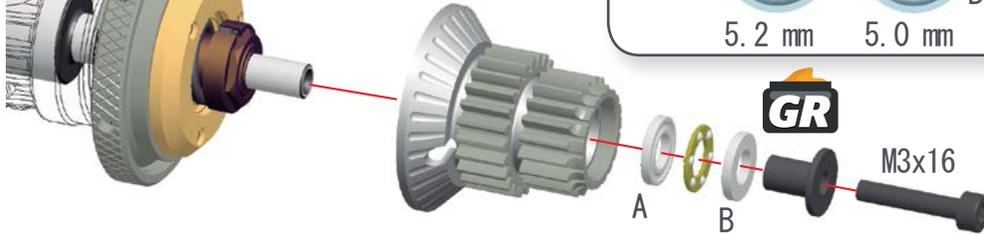
クラッチハウジングをクランクシャフト先端側へ引き寄せた状態でのAの長さ、クラッチハウジングをエンジン側に押し付けた状態でのBの長さの差がクラッチのクリアランスとなります。このクリアランスが0.6~0.8mmになるようにスラストスペーサーとスラストベアリングの間にシムを入れます。
