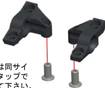
※締め込みが硬い場合は同サイズのスチールビスや、タップで先に軽くねじ切りをして下さい。
