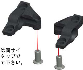
※締め込みが硬い場合は同サイズのスチールビスや、タップで先に軽くねじ切りをして下さい。
